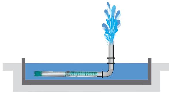
**Bu Resimde ; Dalgıç pompasının Havuzda çalışma şeklini gösterir.
